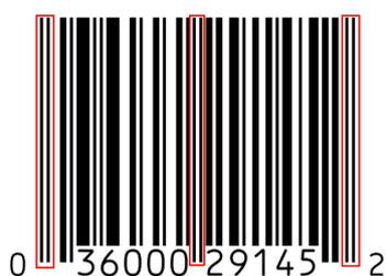
FIGURE 3.1 – Motif de garde sur un code barres EAN-13.
